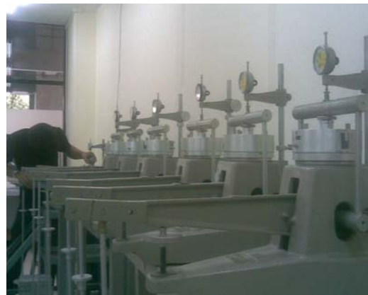
รูปที่ 2 การทดสอบการอัดตัวคายน้ำ
